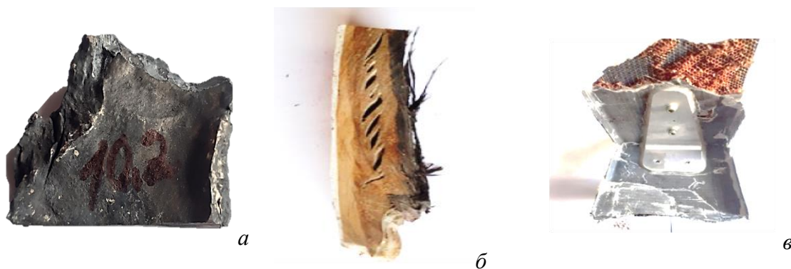
Рис. 1. Приклади уламків засобів ураження: а — металічний фрагмент ракети «Циркон», б, в — композитні фрагменти ракети Hwasong-11 та БПЛА Шахед 136, відповідно.
